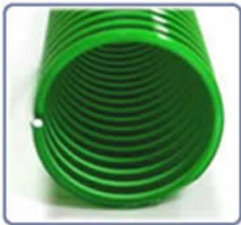
Шланг из пластикового ПВХ, армированный усиливающей спиралью из устойчивого к ударам и давлению ПВХ. Внутренняя поверхность гладкая, внешняя слегка ребристая. Шланг легкий, удобен для манипулирования, гибок. Устойчив к воздействию давления и абразивному износу, к ультрафиолетовому облучению и атмосферным явлениям, к воздействию большого числа химических веществ.
